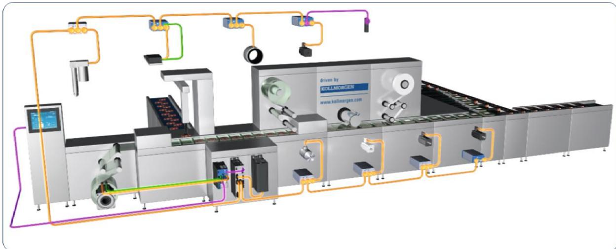
*Eliminate le perdite di potenza dovute al declassamento: la tecnologia decentralizzata di KOLLMORGEN è posizionata direttamente sul motore sotto forma di controller offset.*
